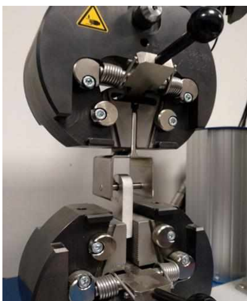
Badania wytrzymałościowe głowicy wirnika na uniwersalnej maszynie wytrzymałościowej
