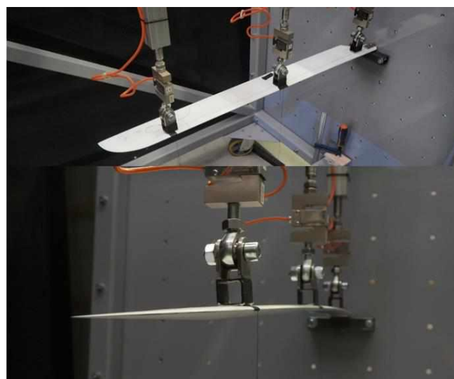
Badania wytrzymałościowe łopat wirnika na uniwersalnej maszynie wytrzymałościowej oraz w klatce wytrzymałościowej
