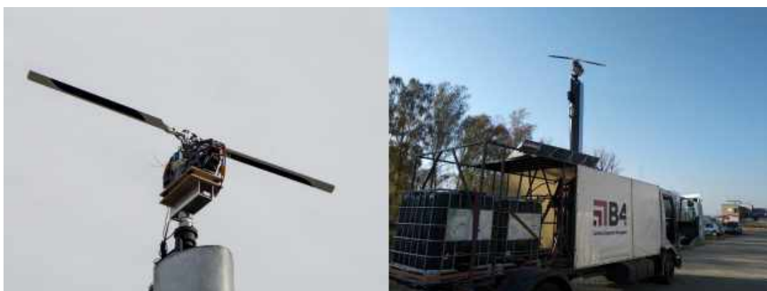
Badania charakterystyk wirników nośnych w zawisie na stanowisku pomiarowym
