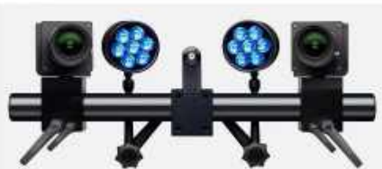
Rys. 2. System GOM ARAMIS do obserwacji i rejestracji przemieszczeń kadłuba
