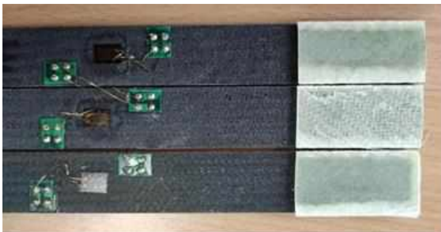
Rys. 3. Czujniki tensometryczne podłączone do taśm zgrzewnych [opr. wł.]
