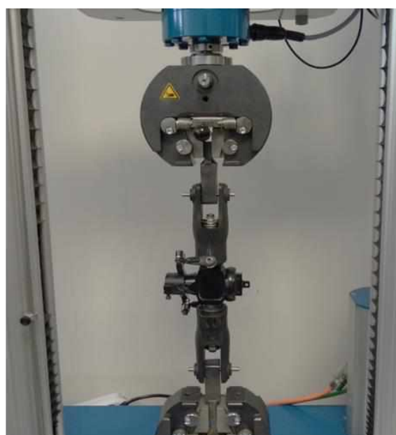
Badania wytrzymałościowe głowicy wirnika na uniwersalnej maszynie wytrzymałościowej
