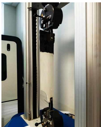
Badania wytrzymałościowe łopat wirnika na uniwersalnej maszynie wytrzymałościowej oraz w klatce wytrzymałościowej
