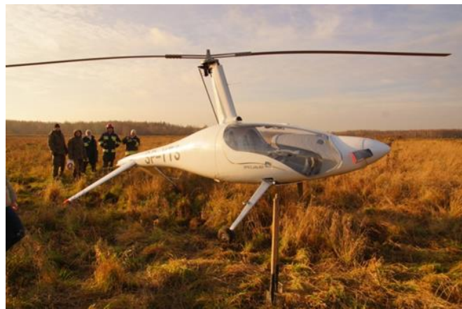
Fot. 4. Przebieg lotu z awaryjnym lądowaniem i uszkodzony wiatrakowiec po wykonaniu manewru lądowania awaryjnego.
