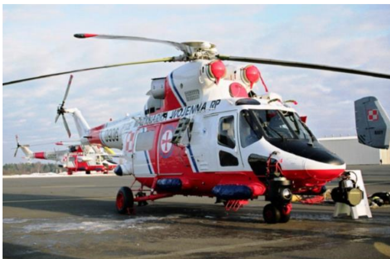
Dopiero ostatni egzemplarz w wersji W-3WARM, dostarczony w styczniu 2002r., miał nowy wariant wyposażenia poszukiwawczego – głowicę optoelektroniczną i sprzężony z nią reflektor. Zdj. Miłosz Rusiecki
