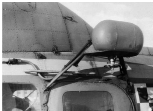
Z lewej: Mi-2RM w charakterystycznym malowaniu wprowadzonym w połowie lat 70. Po prawej francuska wciągarka o napędzie pneumatycznym o udźwigu 250/270 kg, pozwalającym na podniesienie dwóch osób. Zdj. Miłosz Rusiecki
