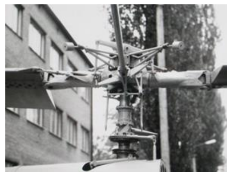
Głowica SP-GIL w wersji pierwotnej z 1950 i finalnej z 1956 r. (z rezonansowym antywibratorem)
