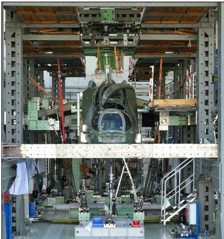
Rys. 8. Montaż śmigłowca na stanowisku próby
