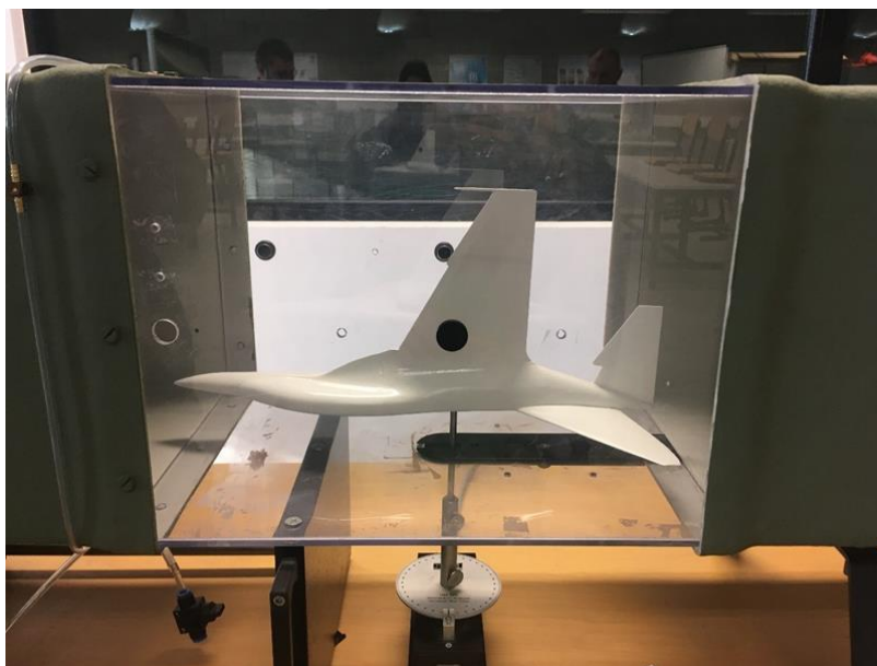
Fot. 3. Model zamocowany w przestrzeni pomiarowej tunelu aerodynamicznego przed rozpoczęciem badań
