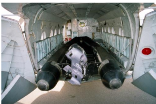
Współczesne działania sił zbrojnych często wymagają nietypowych środków. Z lewej próba z transportowaniem łodzi sztywnokadłubowej (RIB) dla jednostki specjalnej w śmigłowcu Mi-17, po prawej: stanowisko karabinu maszynowego PK kal. 7,62 mm na śmigłowcu Kaman SH-2G.
