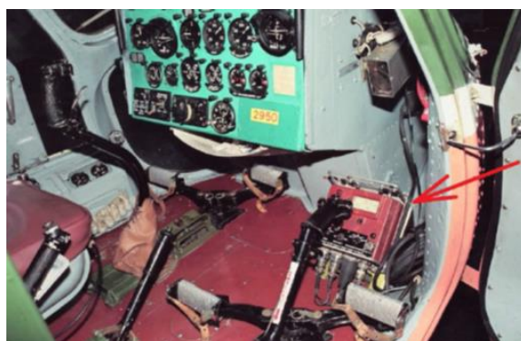
Z lewej: śmigłowce Mi-2Ch „Hekla” Lotnictwa MW stawiają zasłonę dymną podczas ćwiczeń w porcie w Helu, I poł. lat 80. Zdj. Marian Kluczyński Z prawej – rentgenometr pokładowy do wykrywania skażeń promieniotwórczych zamontowany po prawej stronie tablicy przyrządów w ratowniczym Mi-2RM z Darłowa. Zdj. Miłosz Rusiecki
