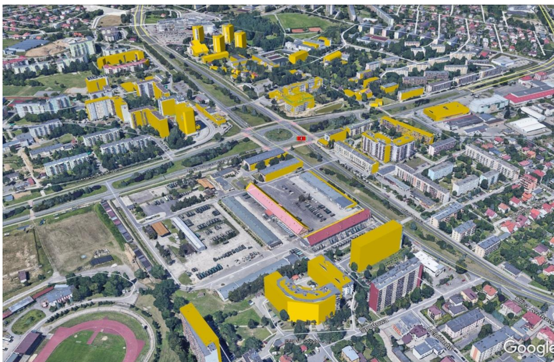
Rys. 32 Ładowisko w Rzeszowie - nałożenie modelu w zrobionego w Google SketchUp-ie (żółty) na model LIDAR-owy fragmentu miasta.
