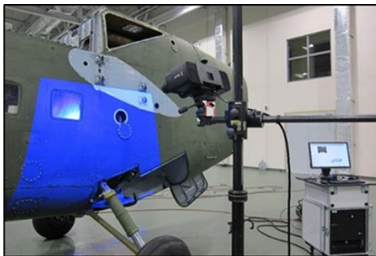
Rys. 2. Skan optyczny powierzchni zewnętrznej
