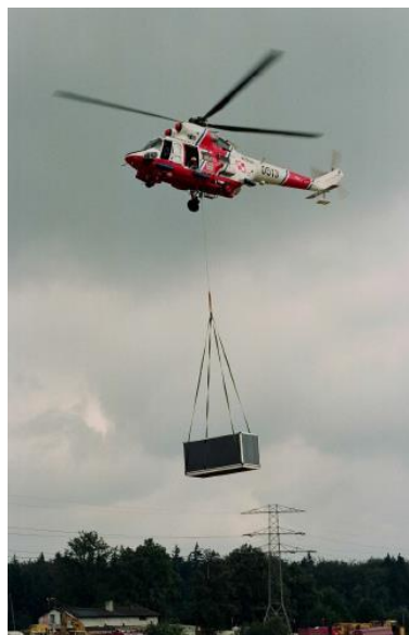
Dwa przykłady wykorzystania śmigłowców LMW w roli latających dźwigów. Z lewej: Mi-14PS ustawia krzyż na wieży kościoła parafii pw. Podwyższenia Krzyża Świętego w Rumi, sierpień 1991r. Zdj. kronika parafialna Po prawej: W-3RM ustawia klimatyzatory na budynku centrum handlowego w Gdańsku, sierpień 1998 r. Zdj. Miłosz Rusiecki
