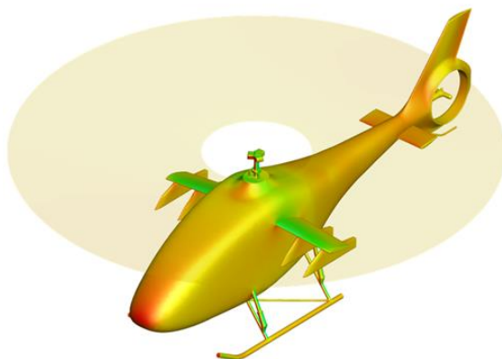
Fot. 2. Prototyp bezzałogowego śmigłowca ILX-27 w locie oraz jego model obliczeniowy z naniesioną mapą rozkładu ciśnienia [3].
