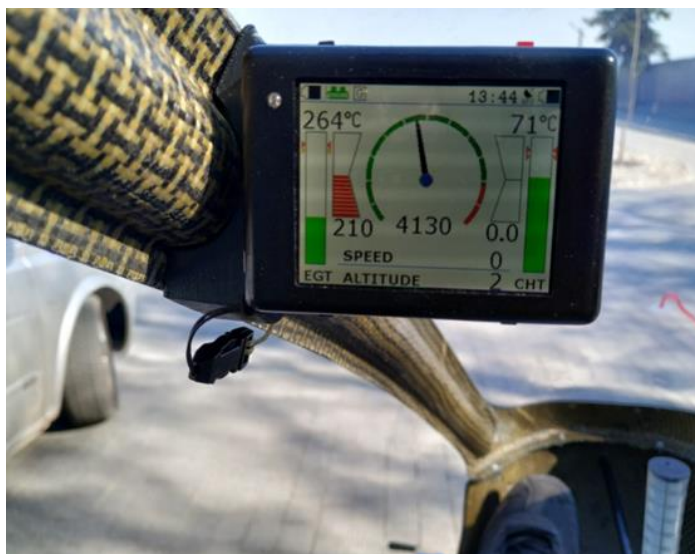
System MotoMonitor firmy Flyelectronics który składa się z pulpitu i nadajnika sygnałów
