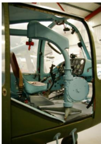
Z lewej: Dźwig elektryczny na SM-2D (egzemplarz zachowany w Helicopter Museum, Weston-super-Mare, Wlk. Brytania), Zdj. Karol Budniak; po prawej: SM-2D z 28 ER sfotografowany podczas rzeczywistego ratowania kierowcy zatopionego transportera w trakcie ćwiczebnego desantu, lipiec 1966 r. i WAF
