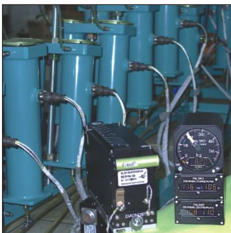
Aparatura do badania paliwomierzy
