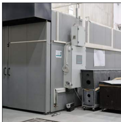
Piec przeznaczony do utwardzania struktur kompozytowych
