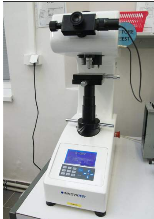
Twardościomierz NEXUS: pomiary mikrotwardości i twardości HV
