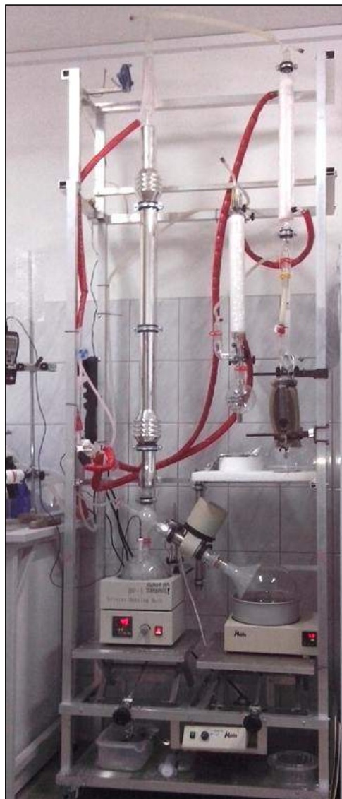
Układ do załężania i oczyszczania nadtlenu wodoru
