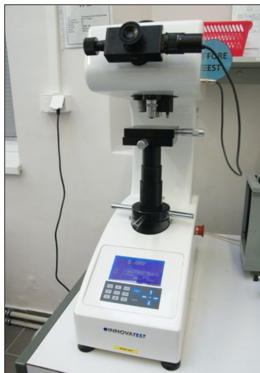
Twardościomierz NEXUS: pomiary mikrotwardości i twardości HV
