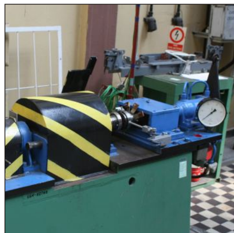
IL 68 stanowisko do badań modelowych okładzin ciernych
