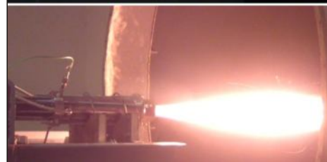
Raketowy silnik hybrydowy w czasie pracy na stanowisku badawczym
