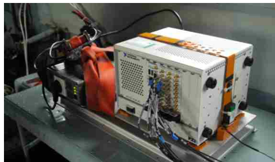
National Instruments PXI-1036 DC (zabudowany na ławeczce na pokładzie śmigłowca)
