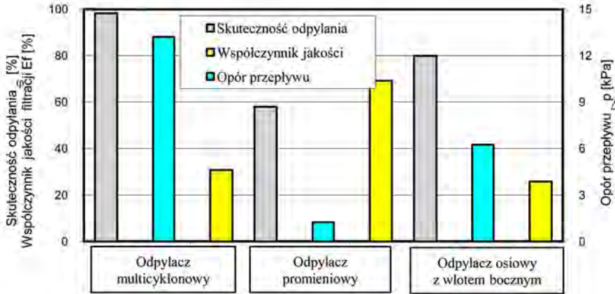
Rys. 8. Skuteczność odpylania i opory przepływu analizowanych odpylaczy bezwładnościowych
