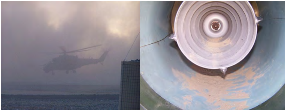
Rys. 8. Zawis śmigłowca w strefie silnego zapylenia i widok kanału dolotowego do jego silnika podczas wykonywania obsługi polotowych
