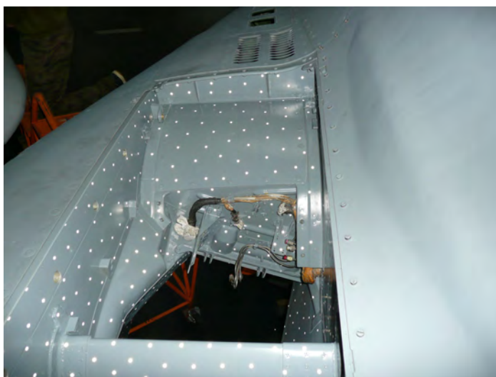
Rys. 12. Górny wlot do silnika samolotu MiG-29 przygotowany do skanowania
