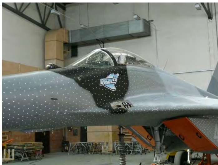
Rys. 4. Wlot samolotu MiG-29 (zakryty), widoczna szczelina pomiędzy dyfuzorem wlotowym, a napływem skrzydła
