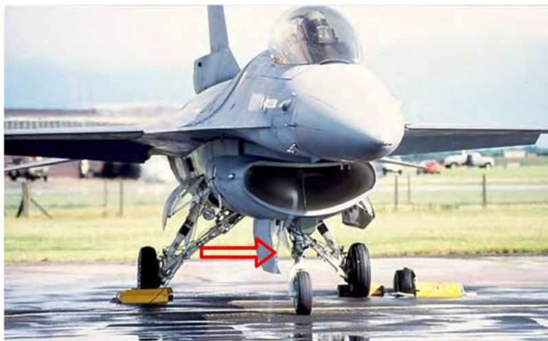
Rys. 6. Powstały wir wlotowy (wskazuje strzałka) na wlocie samolotu F-16
