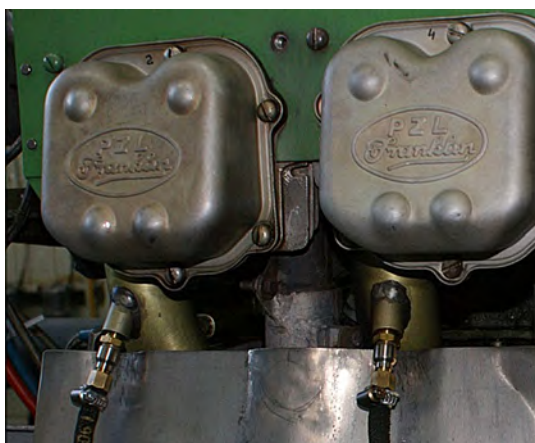
Rys. 9. Widok wtryskiwaczy zamontowanych w kolektorach dolotowych
