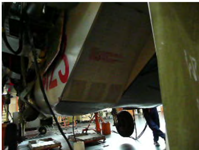
Rys. 3. Wlot samolotu MiG-29 zakryty przednią płytą klina – widoczne perforacje blachy umożliwiające odsysanie warstwy przyściennej
