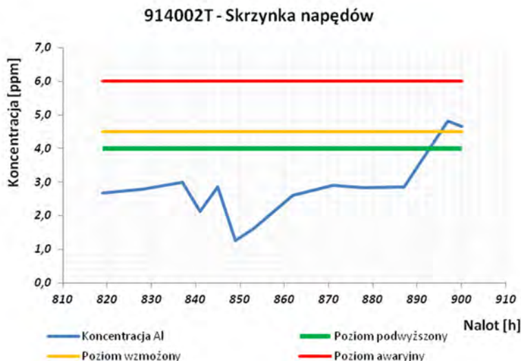
Rys. 7. Przebieg zmian koncentracji aluminium dla próbek ze skrzynki napędów
