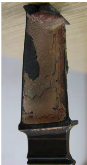
Rys. 10. Łopaska turbiny z przylegającym spieczonym pyłem
