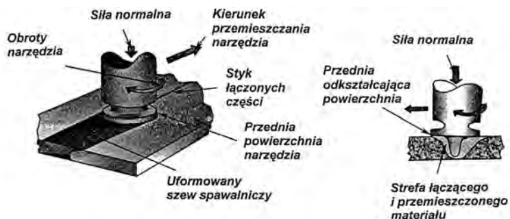
Rys. 3. Schemat przesuwnego zgrzewania tarcowego
