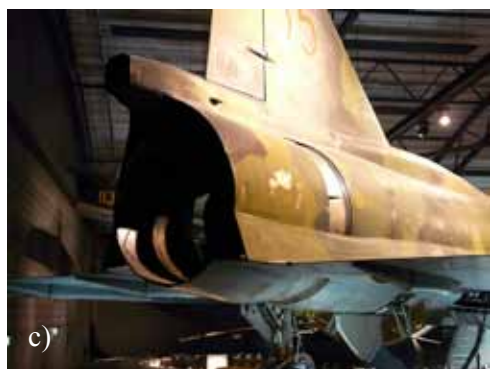
Rys.7.84. Regulowane, dysze wylotowe turbinowych silników odrzutowych z dopalaniem w samolotach (a) F-15 (IWM) i (b) MiG-29 ( Muzeum Lotnictwa Polskiego ) oraz regulowane dysze pozwalające dodatkowo na mieszanie zimnego powietrza z gazami spalinowymi (c) SAAB JA 37 Viggen ( Flygvapenmuseum Linköping ) i (d) Lockheed SR-71 (IWM)
