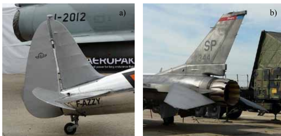
Rys.4.34. a) stery konwencjonalne, b) płytowe usterzenie poziome (Musée de l'Air et de l'Espace Aéroport de Paris)
