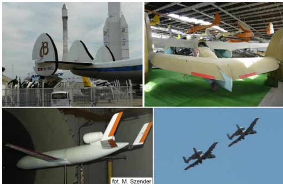
Rys.4.13. Potrójne usterzenie pionowe zmniejsza wysokość samolotu, podwójne poprawia pole ostrzału strzelca. Może też osłaniać dysze silników w celu uniknięcia trafienia, lub zmniejszenia hałasu ( Muzeum Lotnictwa Polskiego w Krakowie, Breitling Collection, Imperial War Museum, Duxford )
