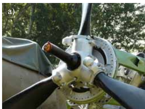
Rys.7.98. Przeciwmasa śmigła samolotu a) Petlakov Pe-2 (Muzeum Wojska Polskiego w Warszawie), Bristol Blenheim (RAF Museum, Hendon)
