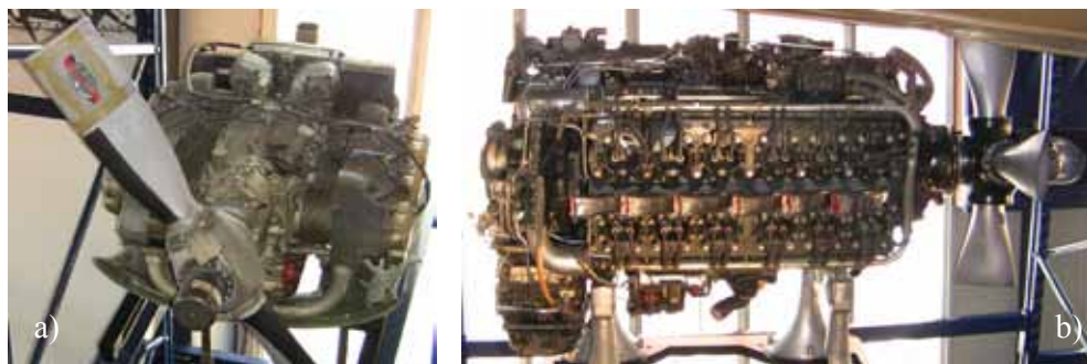
Rys.7.4. a) silnik w układzie bokser chłodzony powietrzem Continental GIO-470-1, b) 24-cylindrowy silnik Napier Sabre w układzie H, chłodzony cieczą ( Science Museum, London )
