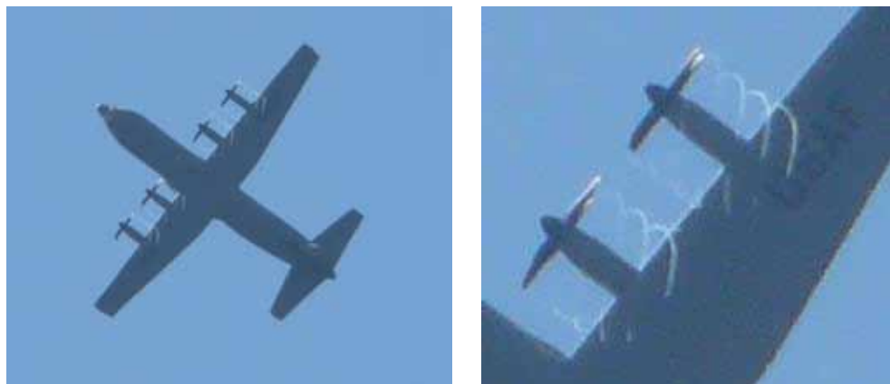
Rys.7.104. Wiry brzegowe wytwarzane na końcówkach łopat śmigieł
