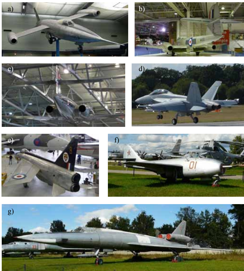
Rys. 7.47. Różne konfiguracje dwusilnikowego napędu odrzutowego w samolotach bojowych a) SO-9000 Trident ( Musée de l’Air et de l’Espace ), b) Gloster Meteor ( RAF Museum, Hendon ), c) Avro Canada CF-100 Canuc ( IWM ), d) F-18 Hornet, e) English Electric Lightning ( IWM ), f) MiG-9, g) Tu-22 ( Центральный Музей Военно-Воздушных Сил )
