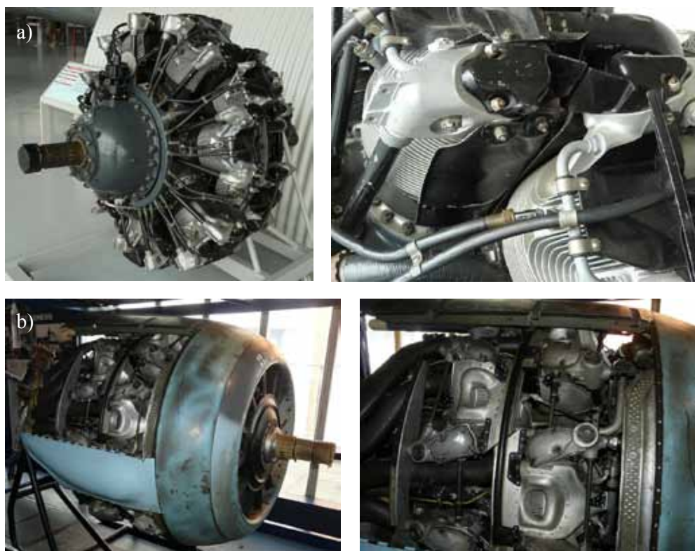
Rys.7.66. Deflektory ułatwiające chłodzenie tylnych stron cylindrów w silnikach gwiazdowych chłodzonych powietrzem: a) Pratt & Whitney Double Wasp 2800B ( Imperial War Museum, Duxford ) i b) BMW-801( Science Museum, London )
