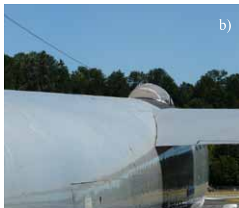
Rys.5.36. a) Dyfuzor powstający w dolnopłatach w miejscu połączenia skrzydła z kadłubem musi być wypełniony owiewką zwaną filetem. b) W górnopłatach dyfuzor nie powstaje, filet nie jest więc bezwzględnie konieczny (Boeing B-47) ( Museum of Flight, Seattle )
