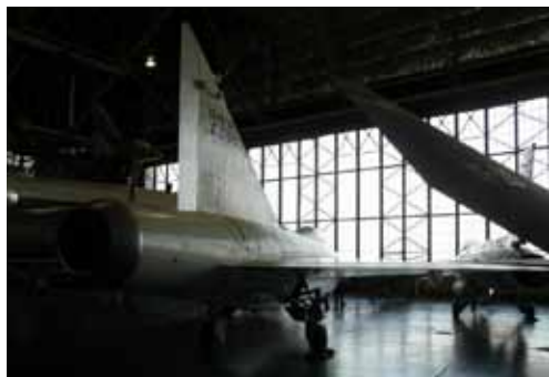
Rys.5.33 Nieudany prototyp samolotu naddźwiękowego Convair XF-92 miał kadłub o kształcie niezgodnym z regułą pól ( National Museum of the U.S. Air Force's, Dayton )
