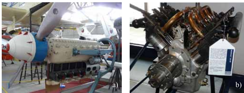
Rys.7.3. a) silnik rzędowy Avia M-137A ( Letecké muzeum Kbely ), b) silnik Renault w układzie V, obydwa chłodzone powietrzem ( Science Museum, London )
