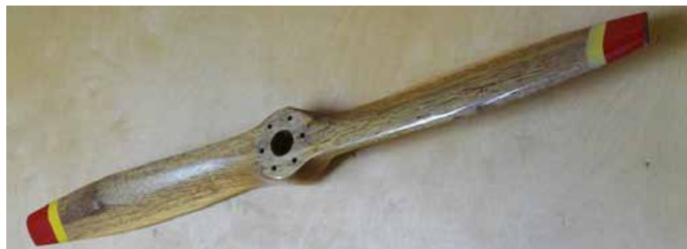
Rys.7.91. Drewniane śmigło o stałym skoku i jego proces wytwarzania ( Museum of Flight, Seattle, RAF Museum, Hendon )
