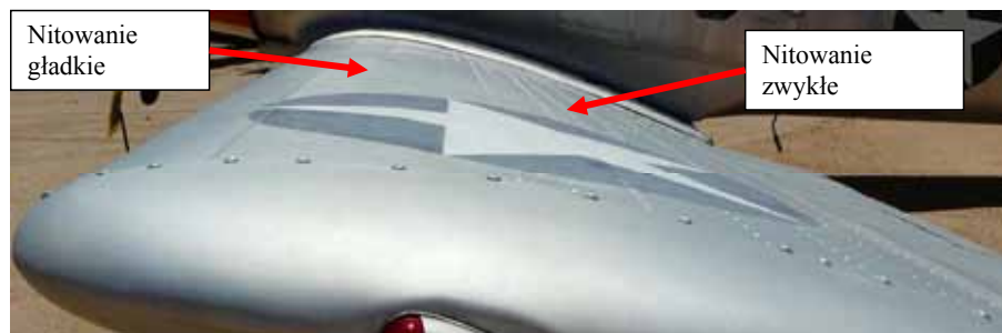
Rys.3.26 „Gładkość” powierzchni skrzydła ma znaczenie w opływie laminarnym, stąd w konstrukcjach metalowych krawędzie natarcia nitowane są nitami z łbami wpuszczanymi. Ponieważ jednak takie nitowanie jest kosztowne, więc w obszarze, w którym opływ laminarny na pewno nie wystąpi, stosuje się zwykłe nity z łbami wypukłymi. (Pima Air Museum)
