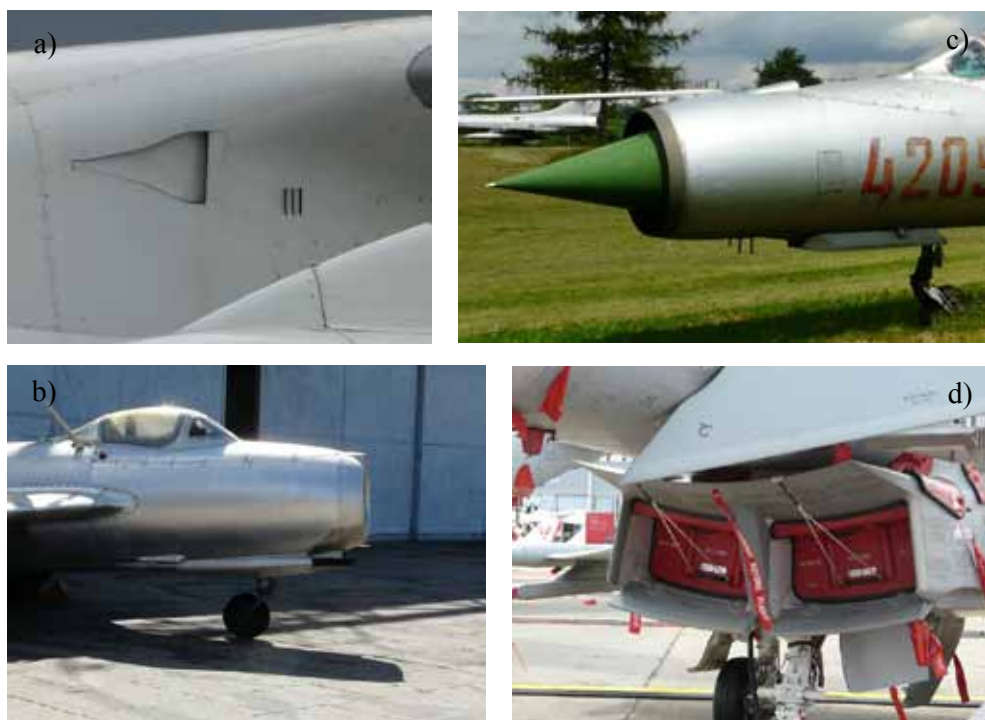
Rys.7.71. Poddźwiękowe wloty powietrza typu (a) NACA i (b) Pitot (Muzeum Lotnictwa Polskiego) oraz naddźwiękowe (c) dwuwymiarowe i (d) trójwymiarowe
