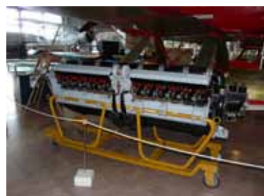
Rys.7.33 Nietypowe dwusilnikowe zespoły napędowe a) Macchi 72 z dwoma silnikami tłokowymi napędzającymi śmigła przeciwbieżne, b) Caproni Campini CC2 z silnikiem tłokowym napędzającym trójstopniową sprężarkę z dopalaczem/silnikiem strumieniowym ( Il Museo Storico dell'Aeronautica Militare Bracciano )
