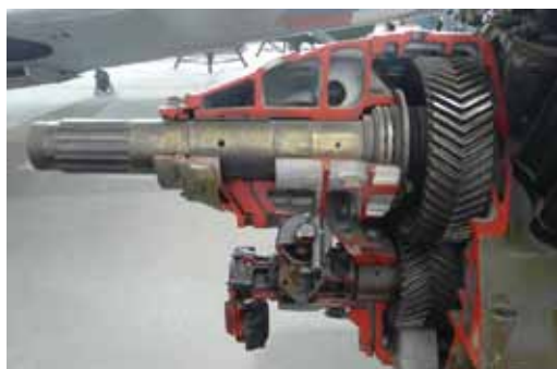
Rys.7.102 Mechaniczno-hydrauliczny regulator prędkości obrotowej śmigła w silniku Mikulin M-42 (И-10) ( Letecké muzeum Kbely ) oraz Szwecow Asz-82 (Ła-5) ( Центральный Музей Военно-Воздушных Сил в Монино )
