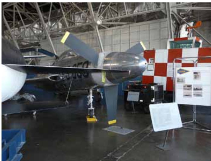
Rys.7.88 Eksperymentalne śmigło naddźwiękowe ( National Museum of the U.S. Air Force's, Dayton )
