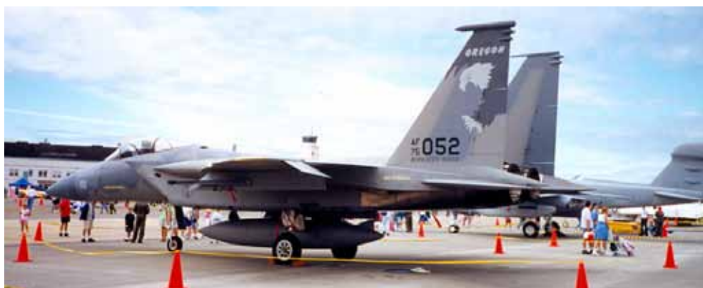
Rys.4.19 Przykład usterzenia mieszanego - T/V z dodatkim wzniosem (Imperial War Museum, Duxford)
