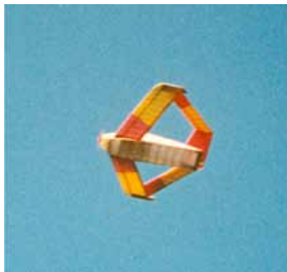
Rys.4.29. Samolot w układzie „zespolonych skrzydeł”.
