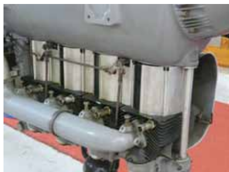
Rys.7.68. Chłodzenie powietrzem silnika rzędowego Avia M-431 (Letecké muzeum Kbely)
