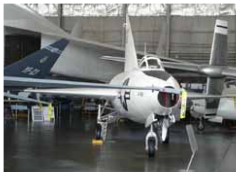
Rys.5.33 Nieudany prototyp samolotu naddźwiękowego Convair XF-92 miał kadłub o kształcie niezgodnym z regułą pól ( National Museum of the U.S. Air Force's, Dayton )
