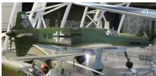
Rys.7.32. Różne konfiguracje wielosilnikowego, śmigłowego zespołu napędowego: a) Convair B-36 ( Pima Air Museum, Tucson ), b) North American B-25 Mitchel ( Imperial War Museum, Duxford ), c) Scaled Composites Boomerang, d) Cessna 336 Skymaster, e) Dornier 335 Pfeil ( The Smithsonian's National Air and Space Museum )
