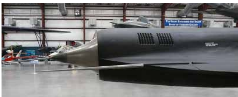
Rys.7.76. Krzywoliniowe ciało centralne we wlocie samolotu bezzałogowego D-21 (Pima Air Museum, Tucson)
