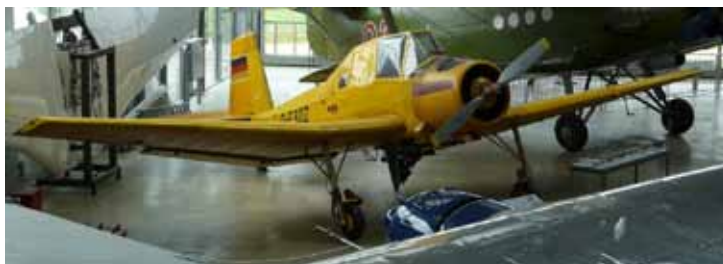
Rys.5.14. a) Typowy układ kadłuba (silnik, zbiornik, kabina) samolotu rolniczego PZL-106 Kruk i b) nietypowy Zlin Cmelak (silnik, kabina, zbiornik) ( Deutsches Museum Flugwerft Schleissheim )
