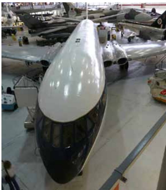
Rys.7.42. Silniki ukryte w nasadach skrzydeł DH-106 Comet ( IWM )
