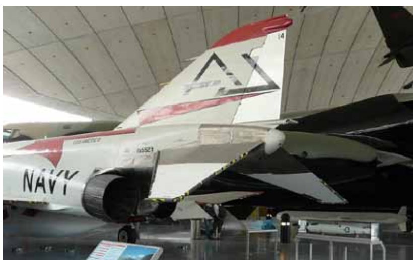
Rys.4.18 Przykład usterzenia mieszanego - konwencjonalne/V z ujemnym wzniosem (Imperial War Museum, Duxford)
