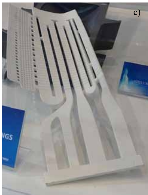
Rys.7.70. a), b) Chłodzone łopatki turbiny silnika odrzutowego, c) rdzeń odlewniczy odwzorowujący kanały chłodzące wewnątrz łopatki
