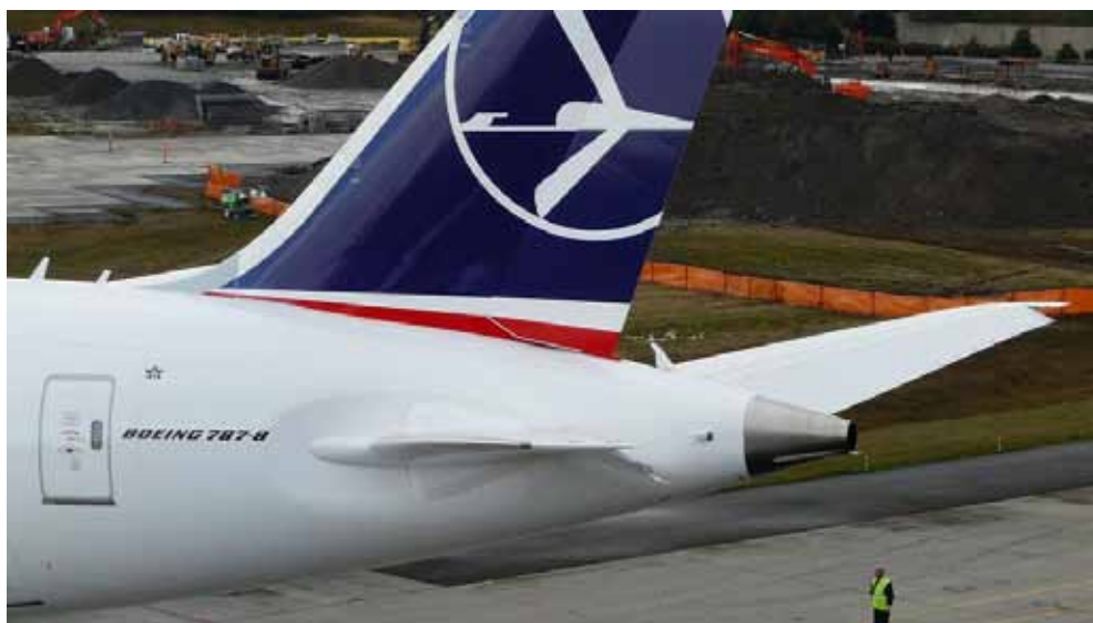
Rys.4.33. Samolot pasażerski z „nośnym” profilem usterzenia poziomego oraz „przestawialnym” statecznikiem poziomym.
