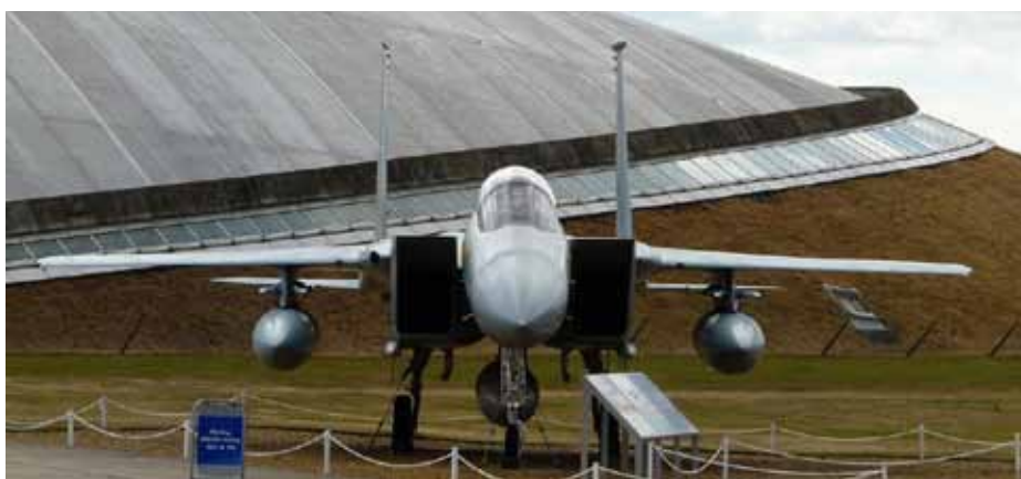
Rys.4.20 F-15 Przykład samolotu z podwójnym usterzeniem pionowym (Imperial War Museum, Duxford)
