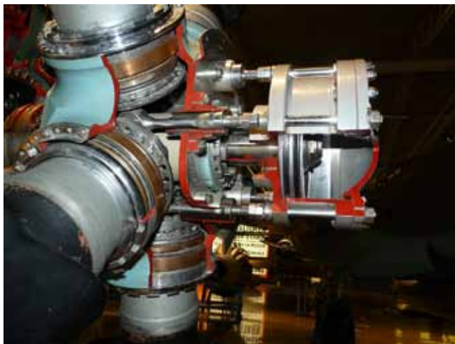
Rys.7.101 Hydrauliczny mechanizm zmiany skoku, z ruchomym cylindrem w samolocie Supermarine Spitfire ( Flygväpennmuseum Linköping )
