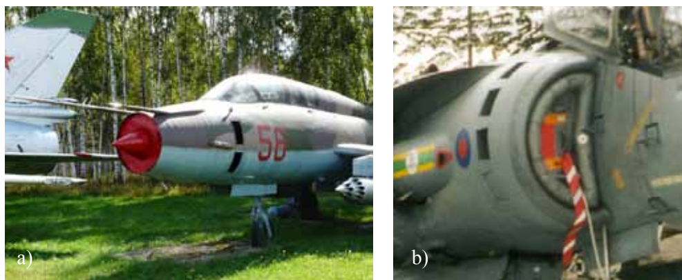
Rys.7.82 Dodatkowe wloty powietrza poprawiające działanie wlotu na dużych kątach natarcia i stabilizujące pracę silnika, (a) Su-22 (Центральный Музей Военно-Воздушных Сил), (b) Hawker Harrier.
