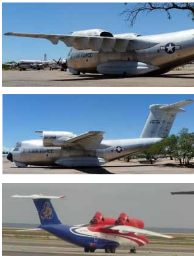
Rys.7.41. Samoloty w których wykorzystano efekt Coandy: Boeing YC-14 (Pima Air Museum, Tucson), An-72
