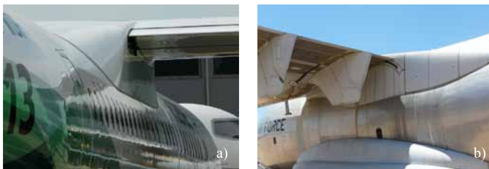
Rys.5.38 Owiewki przejścia skrzydło kadłub w górnopłatach mogą służyć do oprofilowania okuć i napędów klap, a także stanowią powierzchnię brzegową przy wychylonych klapach. a) DHC-8, b) Boeing YC-14 ( Pima Air Museum, Tucson )
