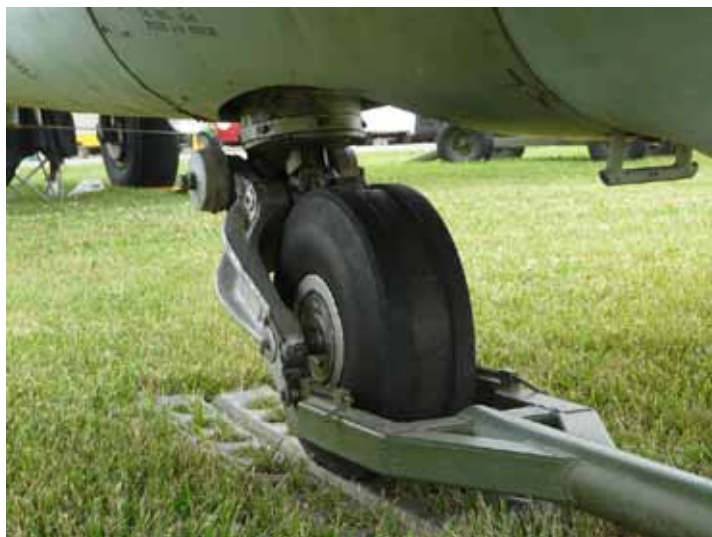
Rys.6.37. Przykłady konstrukcji goleni samonastawnych zapobiegających zjawisku shimmy w samolocie DH Mosquito ( Experimental Aircraft Association Museum, Oshkosh )
