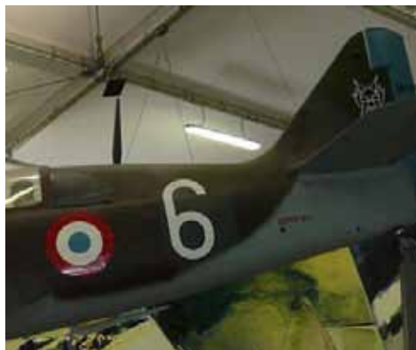
Rys.4.5. Konfiguracje usterzenia ułatwiające wyprowadzanie samolotu z korkociągu (Musée de l'Air et de l'Espace Paris)
