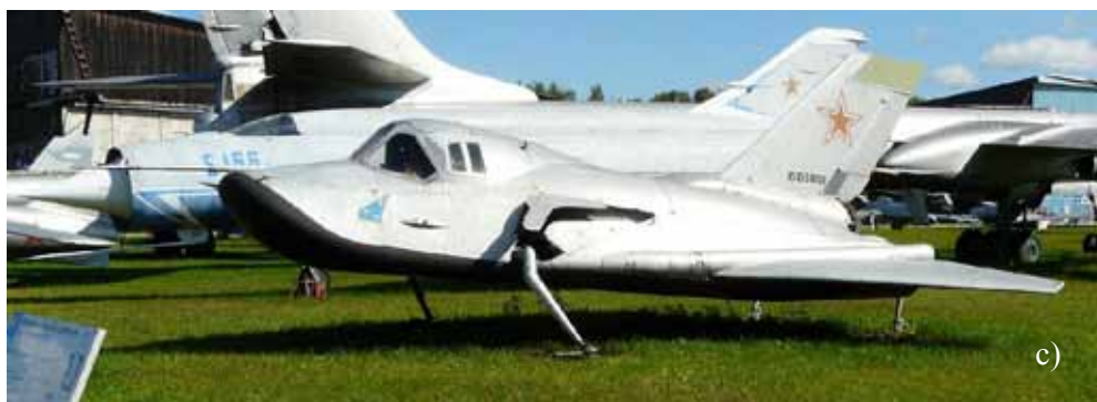
Rys.6.42. Podwozia a) nartowe w samolocie Northrop Gamma ( The Smithsonian's National Air and Space Museum, Washington ), b) płożowo-kołowe Su-7BKL, c) płożowe MiG 105 ( Центральный Музей Военно-Воздушных Сил в Монино )
