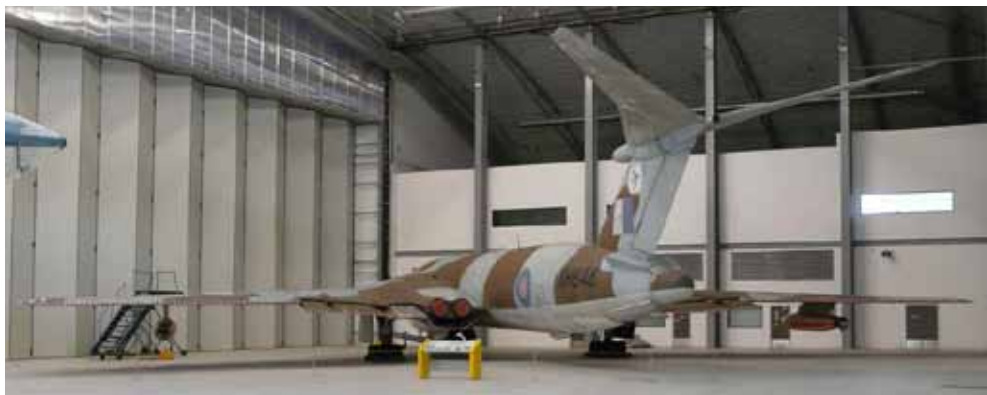
Rys.4.19 Przykład usterzenia mieszanego - T/V z dodatkim wzniosem (Imperial War Museum, Duxford)
