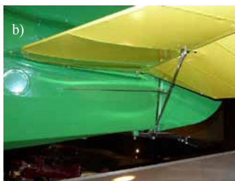
Rys.6.22. Sprężyste podwozie tylne a,b) z płozą i c,d) z kółkiem sterowanym np. przez d) sprężynę zamocowaną do steru kierunku ( Experimental Aircraft Association Museum, Oshkosh )
