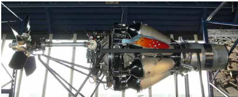
Rys.7.11 Eksperymentalny śmigłowy zespół napędowy z silnikiem turbinowym, zaprojektowany na bazie silnika Rols Royce Dervent ( Science Museum, London )
