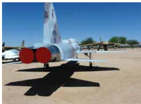
Rys.5.35. Reguła pól zastosowana w kadłubie samolotu northrop Northrop F-5 Tiger ( Pima Air Museum, Tucson )
