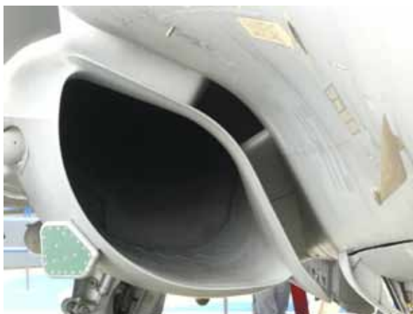
Rys.7.79. Oddzielanie warstwy przyściennej płytą przed wlotem w samolocie Dassault Rafale
