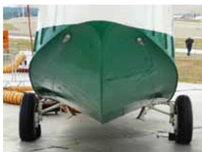
Rys.6.45 Po lewej – charakterystyczny „łodziowy” kształt dna kadłuba, po prawej – redan
