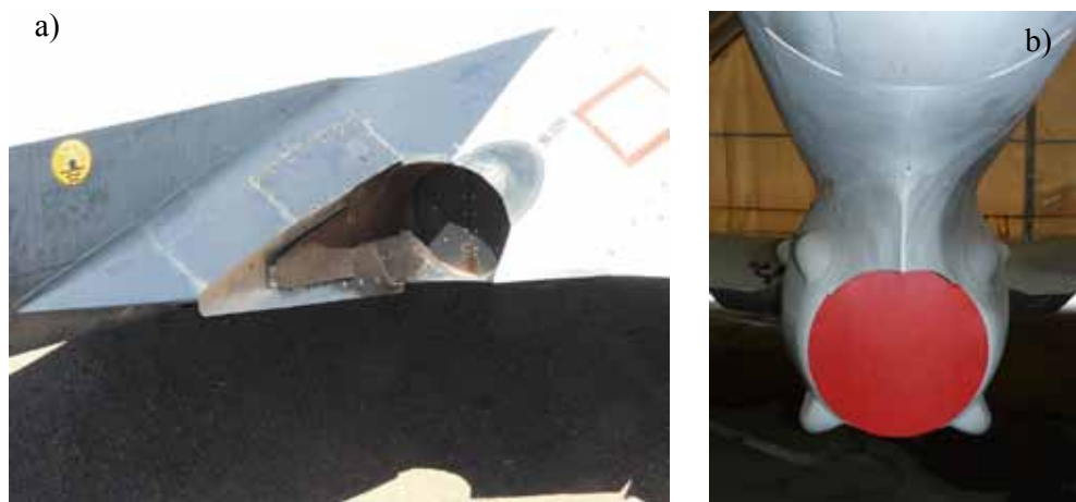
Rys.7.46. Separacja gazów wylotowych od powierzchni kadłuba a) Cessna T-37 Tweet ( Pima Air Museum, Tucson ), b) TS-11 Iskra
