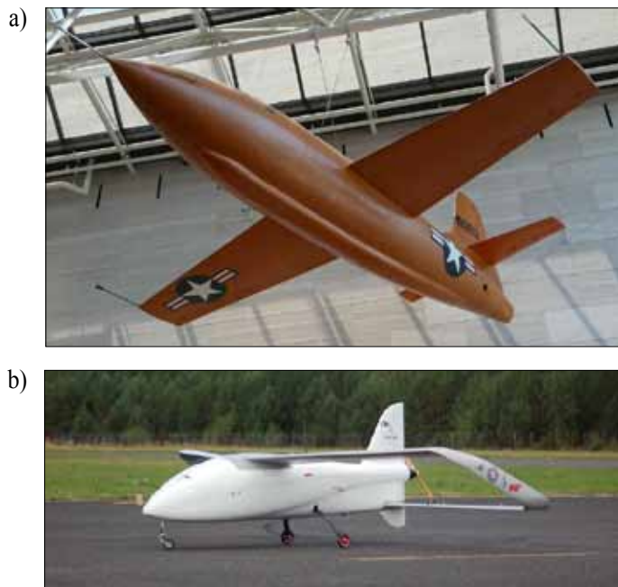
Rys.1.7. a) Samolot doświadczalny X-1, pierwszy samolot naddźwiękowy ( Smithsonian's National Air and Space Museum Washington ); b) dynamicznie podobny model samolotu ILX-32 do badań właściwości układu zespolonych skrzydeł.
