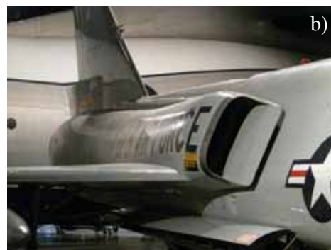
Rys.5.34. a) Owiewki dodane w samolocie Convair F-102 Delta Dagger w celu spełnienia reguły pól ( Pima Air Museum, Tucson ) i b) kadłub samolotu Convair F-106 Delta Dart spełniający regułę pól ( National Museum of the U.S. Air Force's Dayton )
