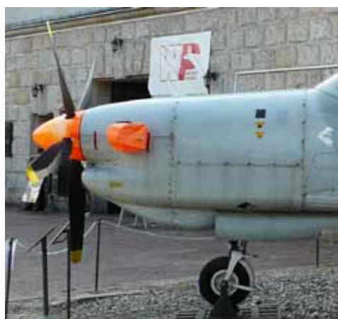
Rys.7.62. Turbinowy silnik śmigłowy PT-6 z odwrotnym kierunkiem przepływu w samolocie PZL 130 Orlik (Muzeum Wojska Polskiego w Warszawie) i montaż tego typu silnika
