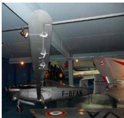
Rys.3.33 Przykład zastosowania ekstremalnie dużego wydłużenia płata w samolocie doświadczalnym Hurel-Dubois H.D.-10 ( Musée de l'Air et de l'Espace )
