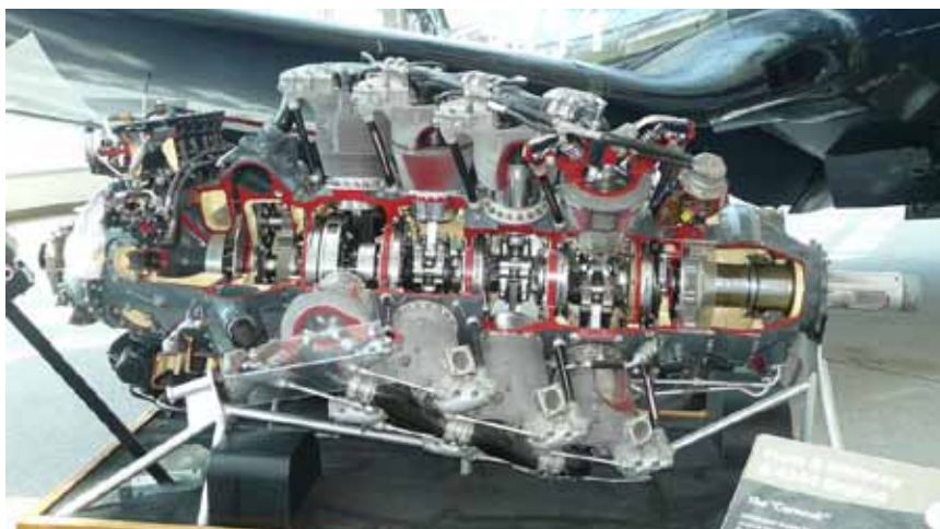
Rys.7.7. Największy zbudowany silnik gwiazdowy Pratt & Whitney R-4360 ( Museum of Flight, Seattle )
