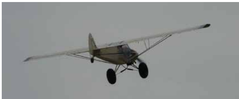
Rys.6.11. Samolot z kółkiem tylnym przystosowany do operowania z lotnisk grząskich
