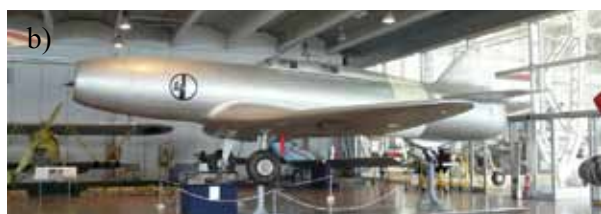
Rys.7.33 Nietypowe dwusilnikowe zespoły napędowe a) Macchi 72 z dwoma silnikami tłokowymi napędzającymi śmigła przeciwbieżne, b) Caproni Campini CC2 z silnikiem tłokowym napędzającym trójstopniową sprężarkę z dopalaczem/silnikiem strumieniowym ( Il Museo Storico dell'Aeronautica Militare Bracciano )
