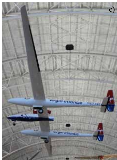
Rys.5.7. Samoloty z dwoma belkami kadłubowymi i gondolą a) Lockheed P-38 Lightning, b) SpaceShipOne i c) Global Flyer ( The Smithsonian's National Air and Space )
