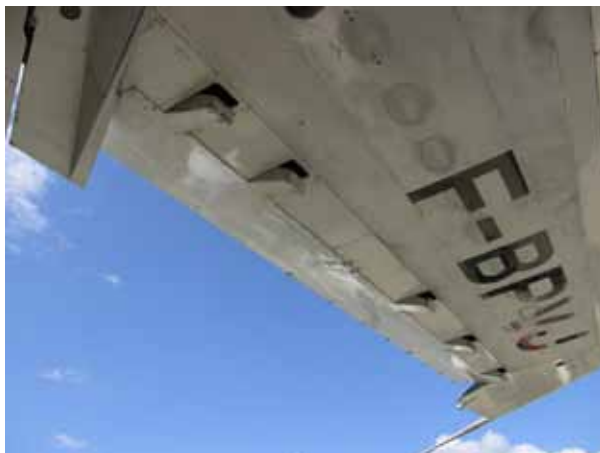
Rys.3.57 Ciekawe rozwiązanie problemu momentu oporowego lotek w samolocie Boeing-747 – hamulce aerodynamiczne wychylane wraz z lotką ( Musée de l’Air et de l’Espace )
