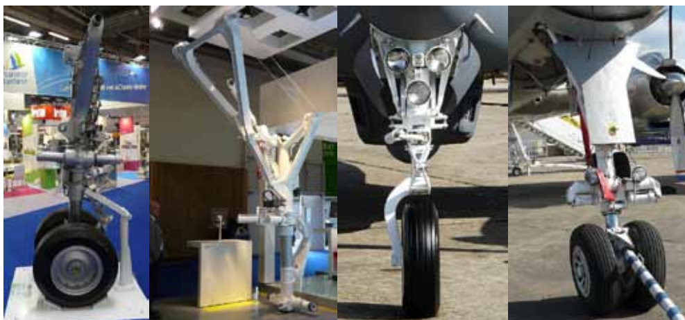
Rys.6.41. Golenie przednie z tłumikami pełniącymi również rolę siłowników sterujących golenią przednią.
