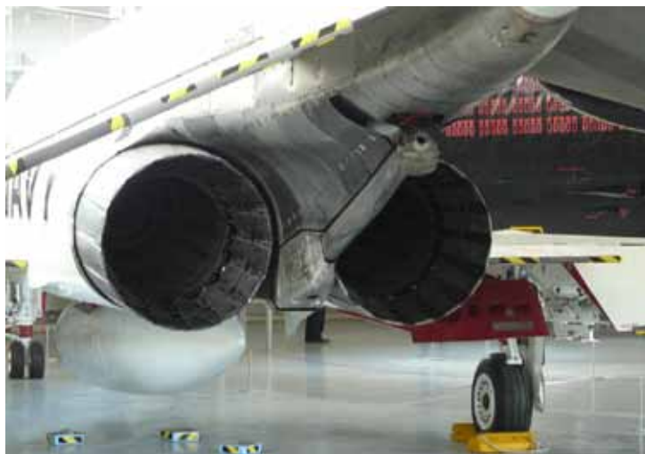
Rys.7.45. Pokrycie kadłuba ze stopu żaroodpornego w okolicy dysz wylotowych silników samolotu McDonnell-Douglas F-4 Phantom ( Imperial War Museum, Duxford )
