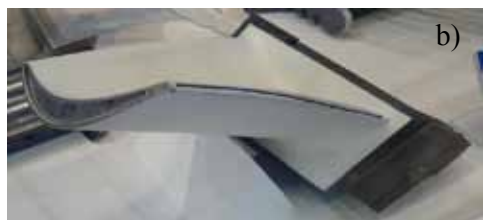
Rys.7.70. a), b) Chłodzone łopatki turbiny silnika odrzutowego, c) rdzeń odlewniczy odwzorowujący kanały chłodzące wewnątrz łopatki
