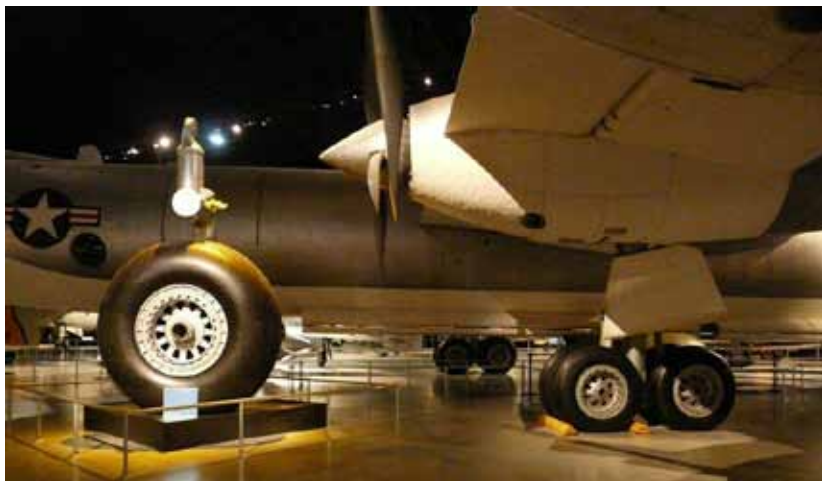
Rys.6.19 Różnica wielkości kół w goleni jednokolowej i w goleni z wózkiem wielokółowym, obydwie stosowano w samolocie Convair B-36 (National Museum of the U.S. Air Force's, Dayton)
