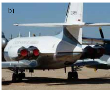
Rys.7.39 Instalacja trzech lub czterech silników w tylnej części kadłuba samolotów dyspozycyjnych (a) Dassault Falcon 900, (b) Lockheed JetStar ( Pima Air Museum, Tucson )
