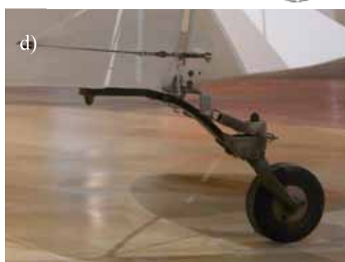
Rys.6.22. Sprężyste podwozie tylne a,b) z płozą i c,d) z kółkiem sterowanym np. przez d) sprężynę zamocowaną do steru kierunku ( Experimental Aircraft Association Museum, Oshkosh )
