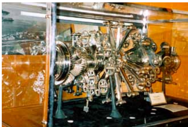
Rys.7.6. Skomplikowana konstrukcja wewnętrzna silnika dwugwiazdowego Bristol Centaurus ( Industrial Museum of Bristol )
