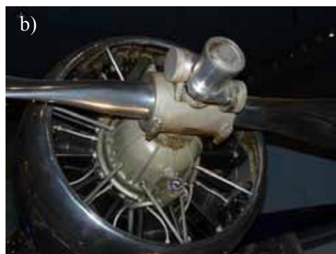
Rys.7.98. Przeciwmasa śmigła samolotu a) Petlakov Pe-2 (Muzeum Wojska Polskiego w Warszawie), Bristol Blenheim (RAF Museum, Hendon)
