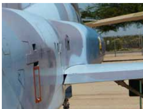
Rys.5.35. Reguła pól zastosowana w kadłubie samolotu northrop Northrop F-5 Tiger ( Pima Air Museum, Tucson )
