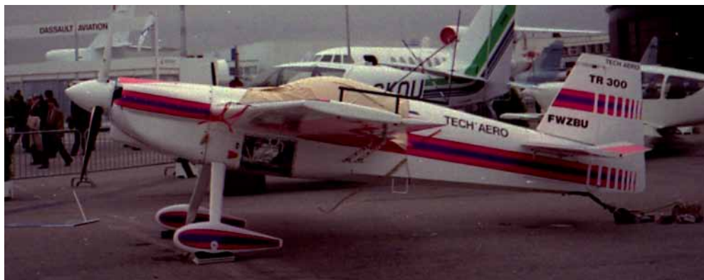
Rys.5.24. Średniopłat – dobry układ dla samolotu akrobacyjnego
