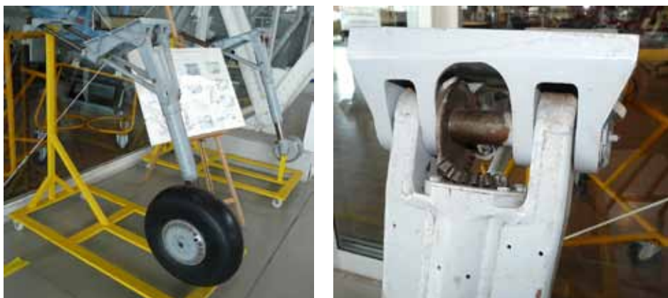
Rys.6.32 Przykład mechanizmu chowającego podwozie w skrzydło ze zmienną płaszczyzną koła wykorzystujący stożkowe koła zębate ( Il Museo Storico dell'Aeronautica Militare Bracciano )
