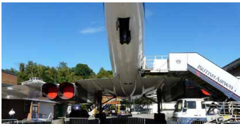
Rys.7.43. Silniki we wspólnych gondolach Concorde ( Brooklands Museum )
