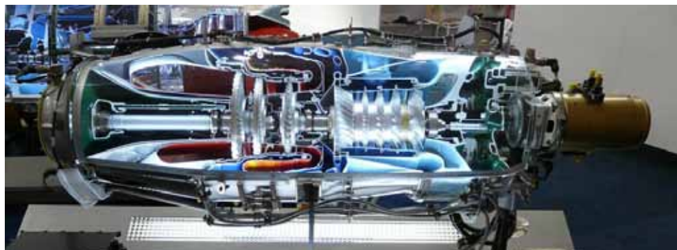
Rys.7.12 Silnik turbinowy Pratt Whitney PT-6 przeznaczony do śmigłowego zespołu napędowego
