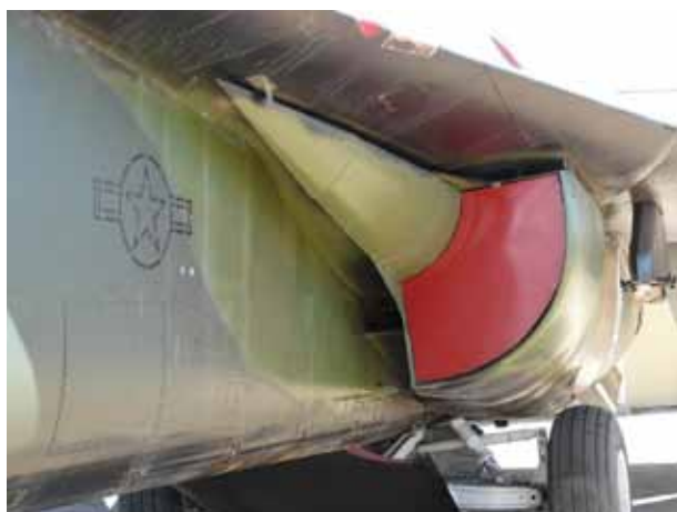
Rys.7.78 Umieszczenie wlotu z boku kadłuba stawia pod znakiem zapytania jego dwuwymiarowość (F-111) ( Pima Air Museum, Tucson ).
