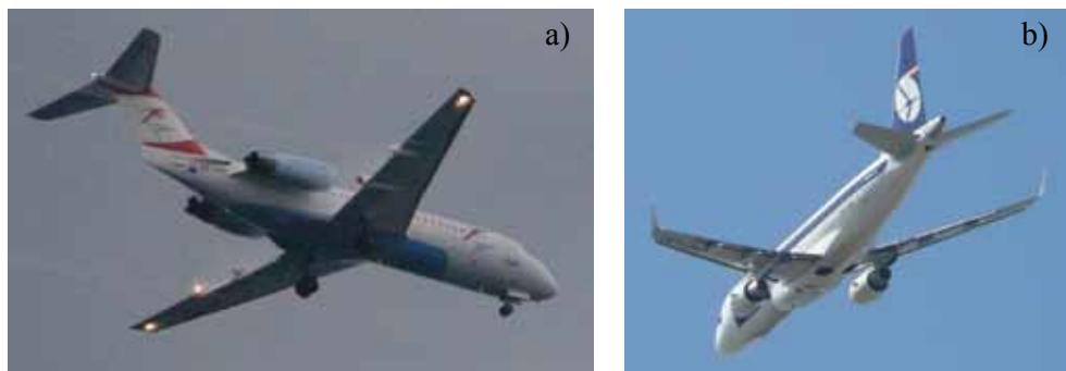
Rys.7.34. Najbardziej popularne konfiguracje odrzutowych zespołów napędowych w samolotach pasażerskich: a) Fokker 100, b) Embraer 170
