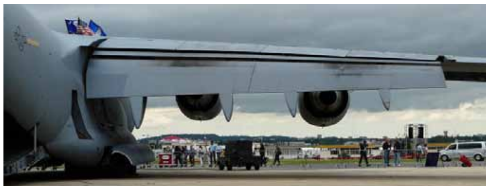
Rys.5.39. Po wychyleniu klapy w górnopłacie, pomiędzy nią, a owiewką skrzydło-kadłub może pozostawać bardzo niewielka szczelina (Boeing C-17)
