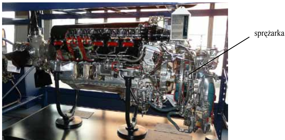
Rys.7.5. 12-cylindrowy silnik tłokowy Rols-Royce Merlin w układzie V, chłodzony cieczą i wyposażony w napędzaną mechanicznie sprężarkę ( Science Museum, London )
