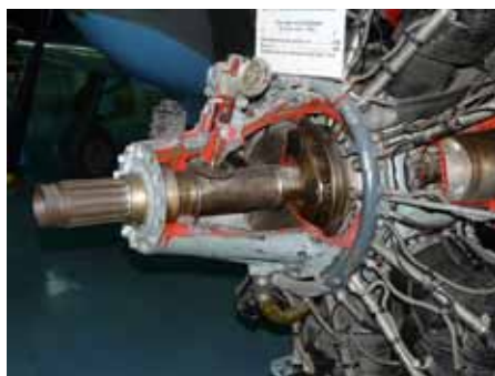
Rys.7.102 Mechaniczno-hydrauliczny regulator prędkości obrotowej śmigła w silniku Mikulin M-42 (И-10) ( Letecké muzeum Kbely ) oraz Szwecow Asz-82 (Ła-5) ( Центральный Музей Военно-Воздушных Сил в Монино )
