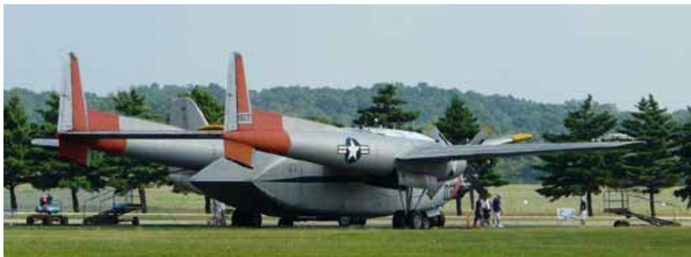
Rys.5.11 Samolot transportowy Fairchild C-119 Boxcar z dwoma belkami kadłubowymi i gondolą ( National Museum of the U.S. Air Force's, Dayton )
