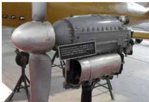
Rys.7.68. Chłodzenie powietrzem silnika rzędowego Avia M-431 (Letecké muzeum Kbely)
