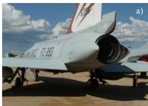
Rys.5.34. a) Owiewki dodane w samolocie Convair F-102 Delta Dagger w celu spełnienia reguły pól ( Pima Air Museum, Tucson ) i b) kadłub samolotu Convair F-106 Delta Dart spełniający regułę pól ( National Museum of the U.S. Air Force's Dayton )
