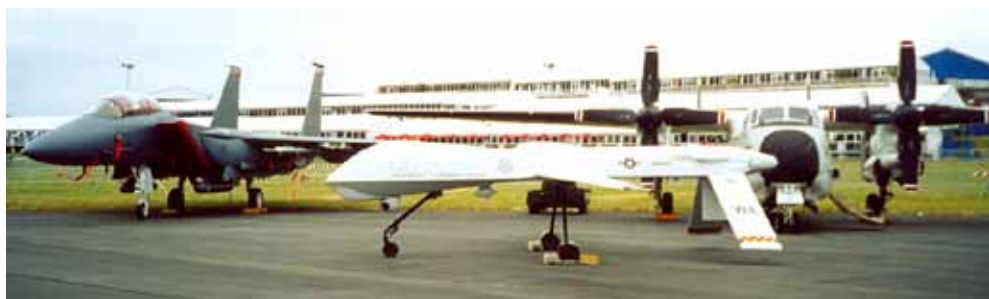
Rys.4.17 Przykład usterzenia V z ujemnym wzniosem zamocowanego pod tylną częścią kadłuba.
