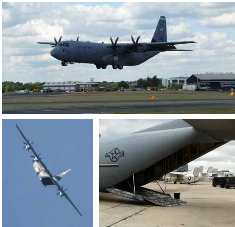
Rys.5.10. Rampa wjazdowa kadłuba samolotu transportowego Lockheed C-130 Hercules.
