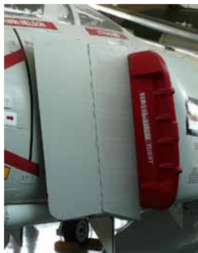
Rys.7.80. Oddzielanie warstwy przyściennej przy pomocy płyty sterującej falą uderzeniową oraz odsysanie warstwy przyściennej przed wlotem samolotu F-4 Phantom (Imperial War Museum, Duxford)
