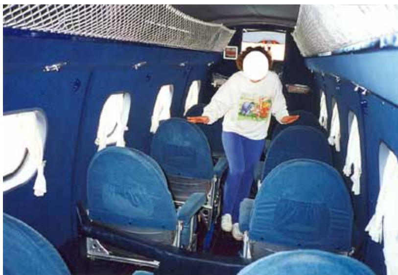
Rys.5.19 Dźwigar skrzydła samolotu Boeing 247, przechodząc przez kabinę pasażerską utrudniał poruszanie się w niej.
