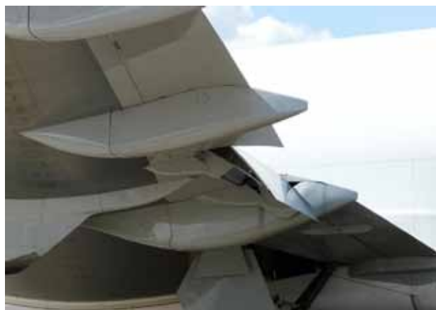
Rys.3.52 a) spoilery w roli hamulców aerodynamicznych, b) lotka dużych prędkości wychylona w dół
