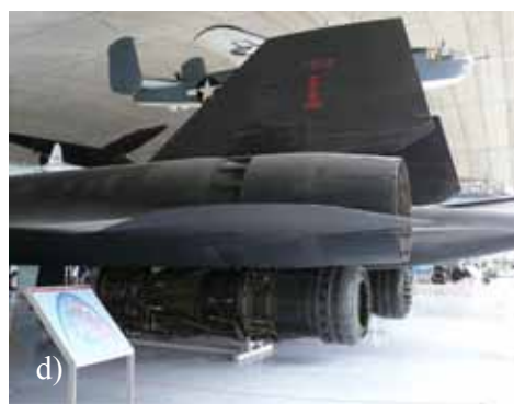
Rys.7.84. Regulowane, dysze wylotowe turbinowych silników odrzutowych z dopalaniem w samolotach (a) F-15 (IWM) i (b) MiG-29 ( Muzeum Lotnictwa Polskiego ) oraz regulowane dysze pozwalające dodatkowo na mieszanie zimnego powietrza z gazami spalinowymi (c) SAAB JA 37 Viggen ( Flygvapenmuseum Linköping ) i (d) Lockheed SR-71 (IWM)
