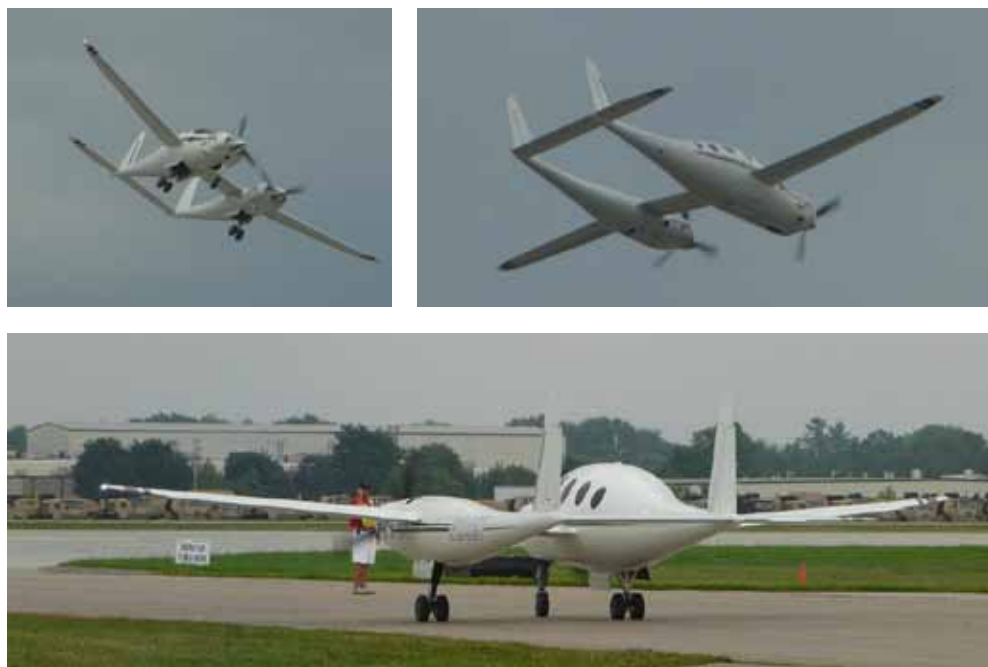
Rys.5.9. niesymetryczny samolot o symetrycznych właściwościach pilotażowych
