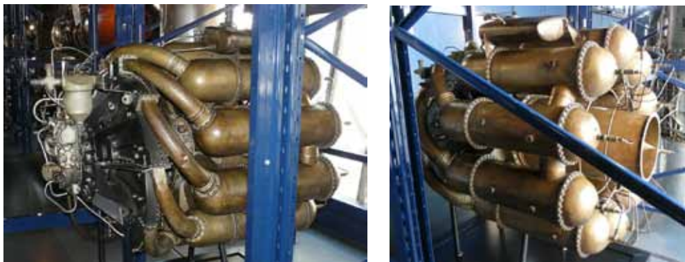
Rys.7.9. Turbinowy silnik odrzutowy zaprojektowany przez Franka Whittle'a (Whittle W-1) ( Science Museum, London )
