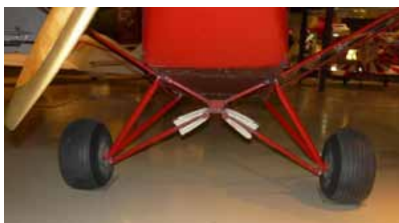
Rys.6.24. Podwozie główne amortyzowane sznurem gumowym ( Museum of Flight, EAA Museum )
