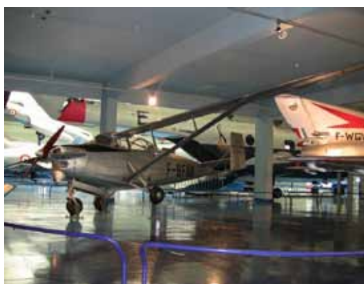
Rys.3.33 Przykład zastosowania ekstremalnie dużego wydłużenia płata w samolocie doświadczalnym Hurel-Dubois H.D.-10 ( Musée de l'Air et de l'Espace )
