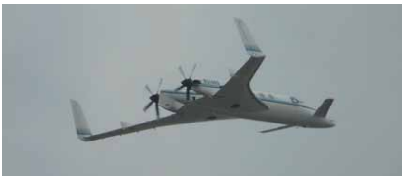
Rys.4.23. Samolot w układzie kaczkii Beechcraft Starship
