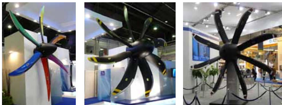
Rys.7.109. Śmigła wielołopatowe (śmigło-wentylatory) ze skosnymi końcówkami łopat
