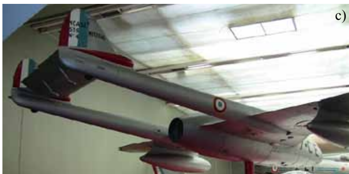
Rys. 7.44. Różne konfiguracje jednosilnikowego odrzutowego zespołu napędowego: a) MiG-21 ( Muzeum Lotnictwa Polskiego ), b) Heinkel He-162 ( IWM ), c) SNCASE 535 Mistral (DH-100 Vampire) ( Musée de l'Air et de l'Espace ), d) Jak-23 ( Центральный Музей Военно-Воздушных Сил )
