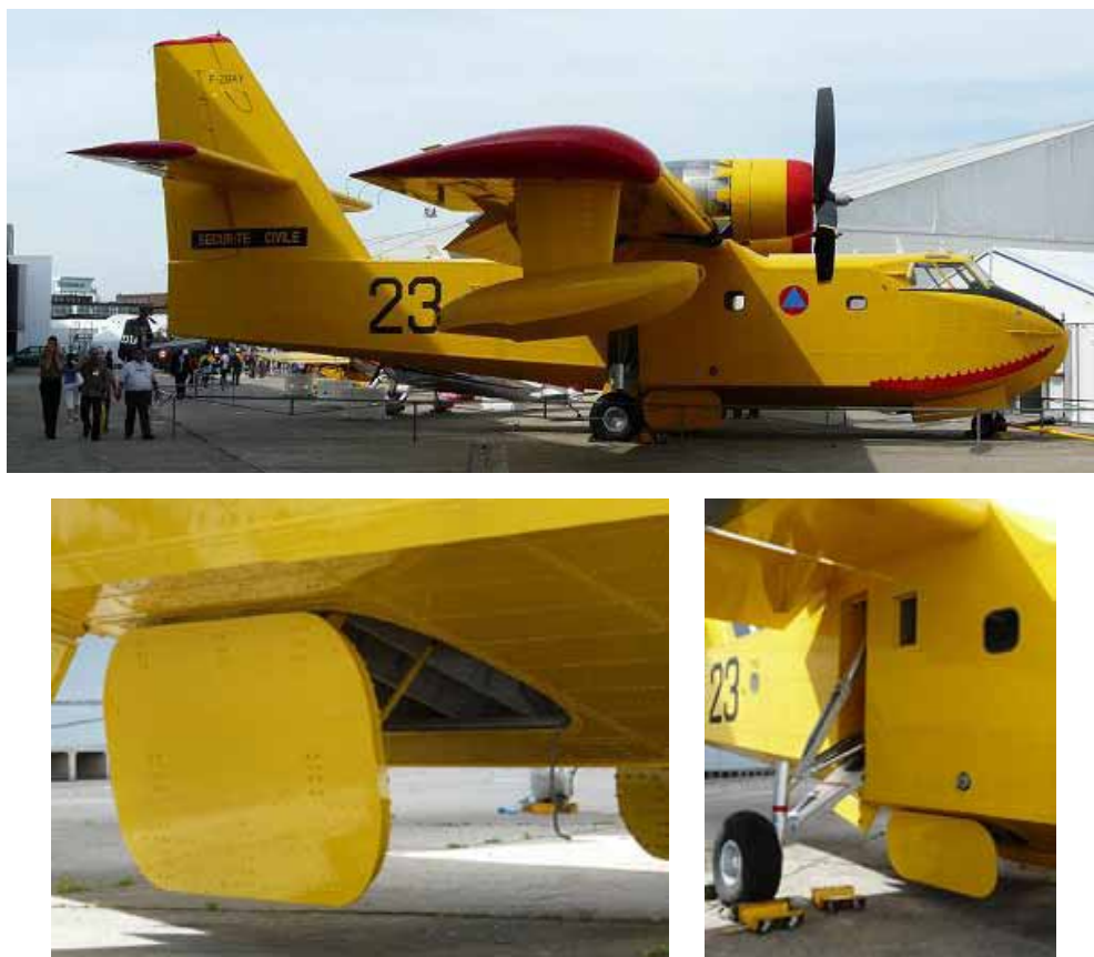
Rys.5.13. Samolot pożarniczy Canadair CL-215 z otwartym lukiem do zrzutu środków gaśniczych ( Musée de l’Air et de l’Espace Aéroport de Paris )
