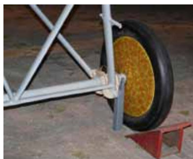
Rys.6.24. Podwozie główne amortyzowane sznurem gumowym ( Museum of Flight, EAA Museum )
