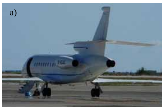
Rys.7.39 Instalacja trzech lub czterech silników w tylnej części kadłuba samolotów dyspozycyjnych (a) Dassault Falcon 900, (b) Lockheed JetStar ( Pima Air Museum, Tucson )
