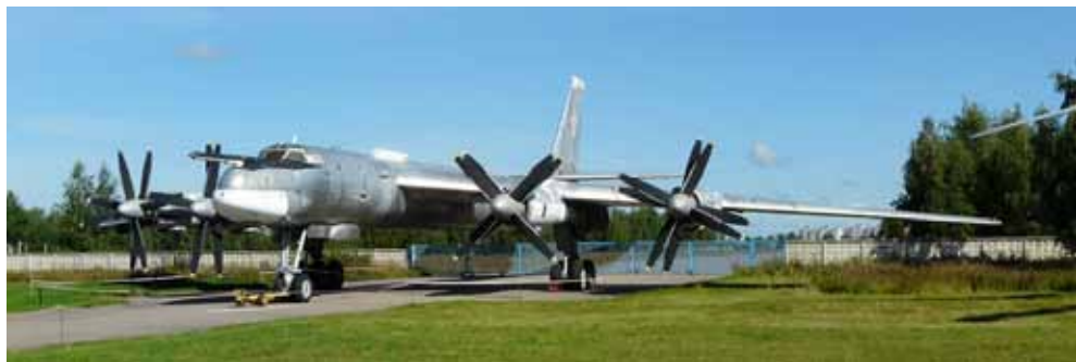
Rrys.7.25. Samolot Tu-95 osiąga co prawda z prędkość Ma=0,85 , ale znany jest jako wyjątkowo hałaśliwy, ze względu na bardzo duże prędkości końcówek łopat śmigieł przeciwbieżnych, jest więc raczej wyjątkiem od reguły (Центральный Музей Военно-Воздушных Сил в Монино)
