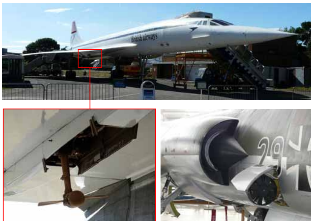
Rys.7.30. Awaryjny generator prądu RAT w samolotach Concorde ( Brooklands Museum ) i F-104 Starfighter ( Deutsches Museum Flugwerft Schleissheim )
