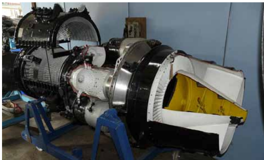
Rys.7.13. Jednoprzeływowy turbinowy silnik odrzutowy ze sprężarką osiową Rolls Royce Avon ( Brooklands Museum )
