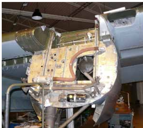
Rys.7.64. Ściana ogniowa za silnikiem w samolocie SAAB B-18 ( Flygvapenmuseum Linköping )
