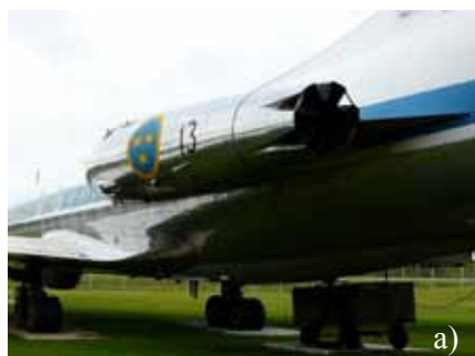
Rys 7.15 Dysze mieszające strumień powietrza i/lub spalin w celu zmniejszenia hałasu: a) w jednoprzepływowym silniku odrzutowym samolotu Caravelle ( Flygvägmuseet Linköping ), b) w wentylatorowym silniku samolotu Boeing 787
