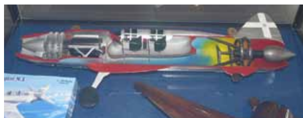
Rys.7.33 Nietypowe dwusilnikowe zespoły napędowe a) Macchi 72 z dwoma silnikami tłokowymi napędzającymi śmigła przeciwbieżne, b) Caproni Campini CC2 z silnikiem tłokowym napędzającym trójstopniową sprężarkę z dopalaczem/silnikiem strumieniowym ( Il Museo Storico dell'Aeronautica Militare Bracciano )
