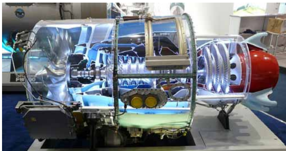
Rys.7.14. Dwuprzeływowy turbinowy silnik odrzutowy z dyszą wylotową mieszającą strumienie powietrza i spalin
