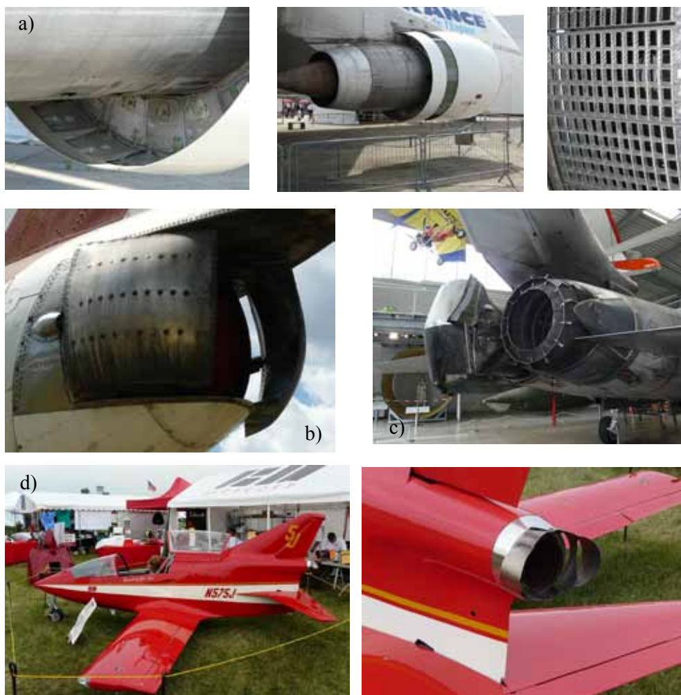
Rys 7.86. Odwracacze ciągu w samolotach (a) Boeing 747 ( Musée de l’Air et de l’Espace ), (b) Jak 40 ( Muzeum Lotnictwa Polskiego ), (c) Panavia Tornado ( Deutsches Museum Flugwerft ) i (d) BD-5
