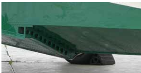
Rys.6.45 Po lewej – charakterystyczny „łodziowy” kształt dna kadłuba, po prawej – redan
