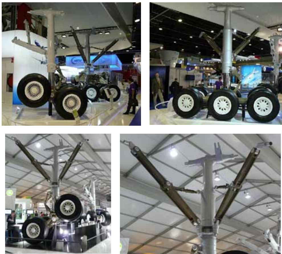
Rys.6.33. Wózkowe podwozia współczesnych samolotów pasażerskich
