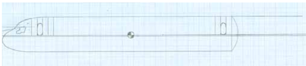
Rys.8.12. Rozmieszczenie tylnych toalet, kuchni, wejść i lokalizacja tylnej wręgi ciśnieniowej
