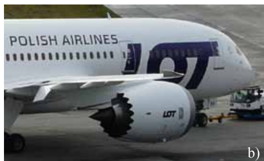
Rys 7.15 Dysze mieszające strumień powietrza i/lub spalin w celu zmniejszenia hałasu: a) w jednoprzepływowym silniku odrzutowym samolotu Caravelle ( Flygvägmuseet Linköping ), b) w wentylatorowym silniku samolotu Boeing 787
