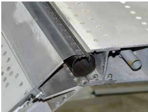
Rys.3.63 Kłapa wysklepiąca z nadmuchem ze sprężarki silnika w samolocie Lockheed F-104 Starfighter. (Deutsches Museum Flugwerft Schleissheim)
